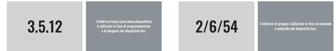
Per coordinare più dispositivi nello svolgimento di una particolare funzione bus si usa invece il cosiddetto indirizzo di gruppo; esso viene rappresentato nella forma caratteristica a due livelli "gruppo principale/sottogruppo" (ad esempio 2/15) o a tre livelli "gruppo principale/intermedio/sottogruppo" (ad esempio 2/6/54). Come indirizzo "destinazione" di un telegramma si usa pressoché esclusivamente questo tipo di indirizzo.
