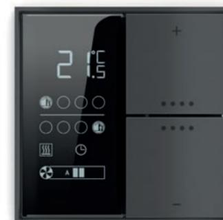
I termostati vengono collegati al solo cavo bus di segnale e non necessitano di alimentazione ausiliaria; si tratta di dispositivi alimentati in bassissima tensione SELV (Safety Extra Low Voltage) che offrono un livello di sicurezza superiore rispetto ai comandi tradizionali. La configurazione e la messa in servizio dei dispositivi viene effettuata mediante il software ETS®; i relativi programmi applicativi sono scaricabili dal sito [www.ekinex.com](http://www.ekinex.com).
